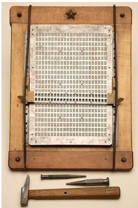
Figura 7. Pauta para fabricar clichés de impresión a mano (principios del siglo XX)
