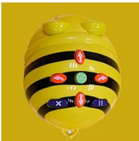
Figura 2. Botones del robot Bee-Bot
