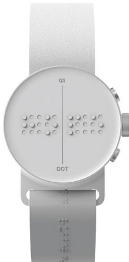
El reloj inteligente Dot tiene una pantalla táctil tradicional, pero configurada según el código braille para permitir manipular el dispositivo, una alternativa para personalizar los mensajes y la información digital que pueden manejar las personas con discapacidad visual.
