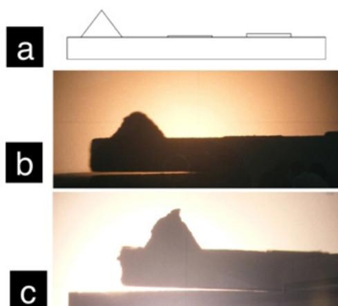
Por otra parte, en la Pieza 2.2 (Figura 10), en la que se reproducía código braille, nuevamente se aprecia una reproducción en altura (h) y diámetro (a) de las piezas obtenidas por ambas técnicas (Tabla 5). Curiosamente, la técnica 3DP obtiene para este caso unos valores menos satisfactorios en cuanto a las dimensiones del diámetro,
