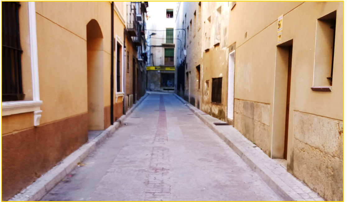
Imaxe 1. Rúa onde se xustifica a implantación dunha plataforma única por ter beirarrúas estreitas e intransitables para os peóns.
