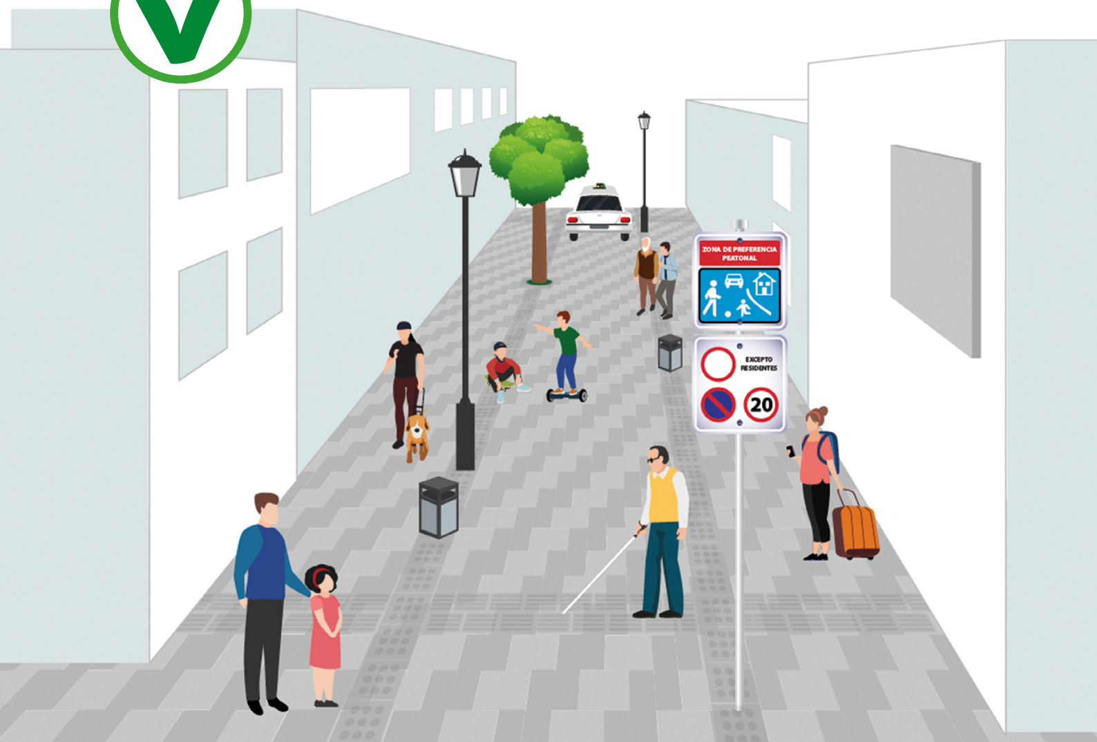
Imaxe 20. Pavimento direccional que comunica ambas zonas de maior seguridade.
