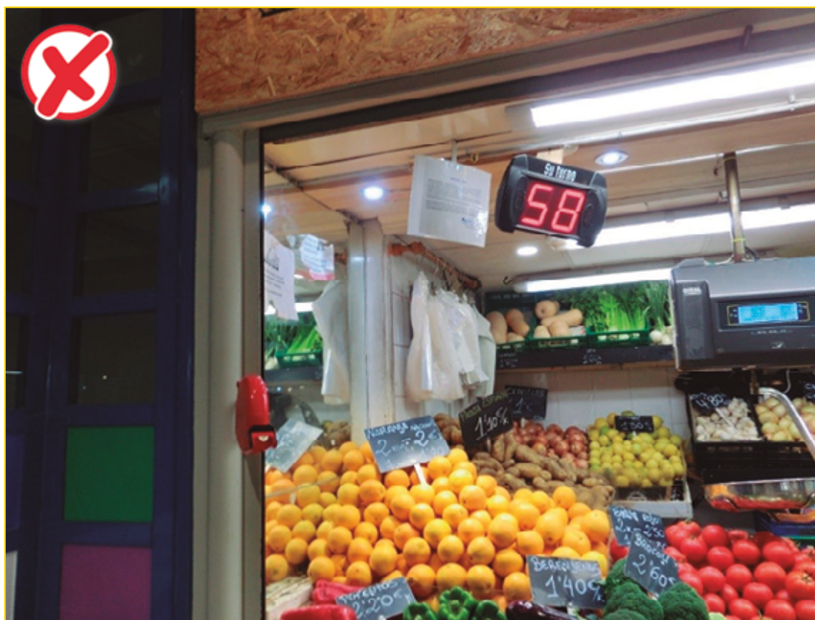
Imagen 31. Gestor de turnos ubicado en zona poco predecible, con escasa diferenciación visual respecto al entorno y posible deslumbramiento por focos cercanos.
