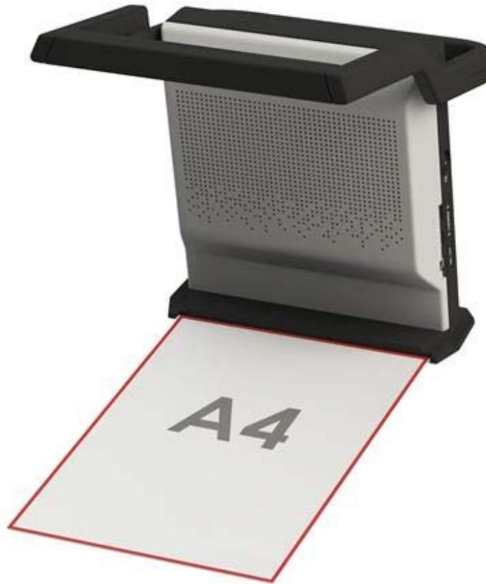
La unidad puede procesar con OCR una hoja de papel A4. Coloque el lado corto del papel entre las guías del pie de la unidad.
