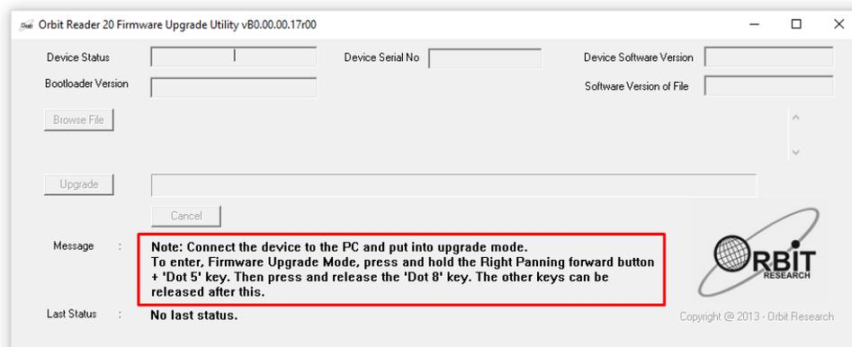
4. Pulse y mantenga pulsada la parte inferior de la Tecla de navegación derecho más el punto 5, pulse y suelte el punto 8. La utilidad muestra el mensaje “Orbit Reader 20 Plus is connected” en el campo de estado del dispositivo. Se muestra el mensaje “Do you want to upgrade the device?” en el campo de mensaje de la parte inferior del cuadro de diálogo.
