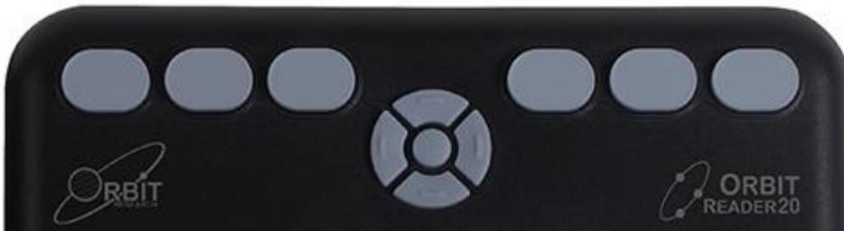
En “Modo Local”, las teclas braille se utilizan para el desplazamiento y la edición/escritura.
